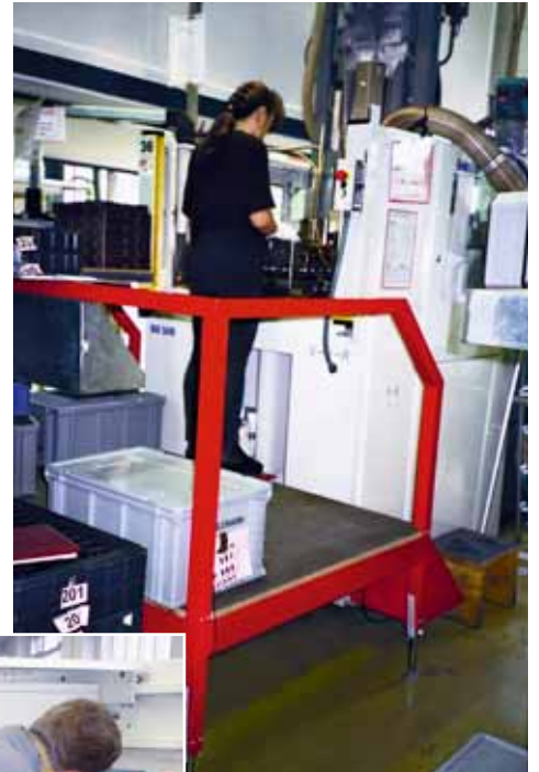
Bild 20 Elektrisch höhenverstellbares Arbeitspodest.
