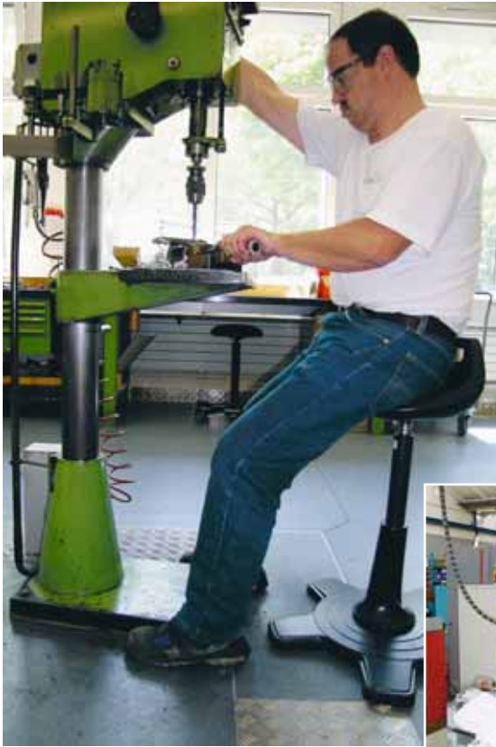
Bild 17 Elektrisch höhenverstellbarer Montageständer.
